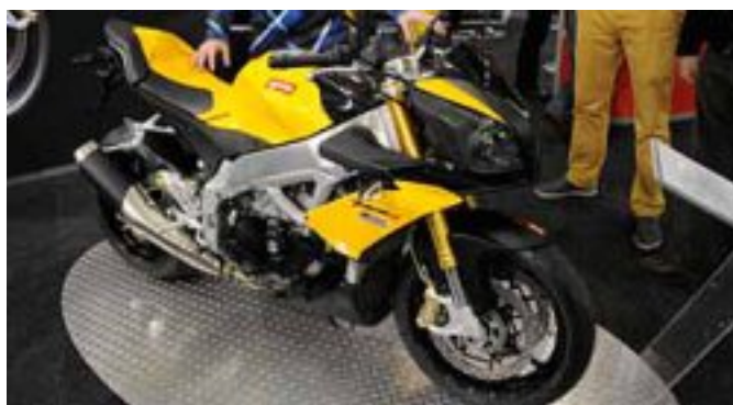
Marke: APRILIA Typ: V4R Tuono Motor: 4-Zylinder 65°-V-Motor / 167PS / 999ccm Gewicht: 203 kg Preis: ab € 14.995,-
