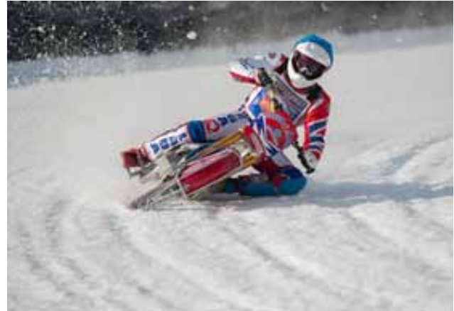
Eisspeedway, die Innenlage ist durch die langen Spikes in den Reifen möglich
